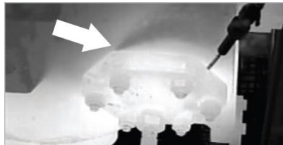
El Sniffer (lado derecho) está detectando gas, pero es incapaz de encontrar su localización. En contra partida, la GF306 muestra claramente el punto de fuga.
