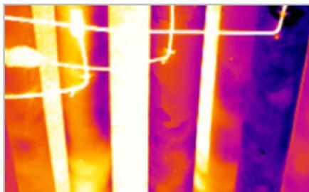
Esta imagen infrarroja muestra las aéreas aisladas de los tubos sobrecalentados, las cuales no se detectaron con los termopares de temperatura. Este error termina comúnmente en una falla del tubo. Se presentan coquificación y escamas desaparejas.
